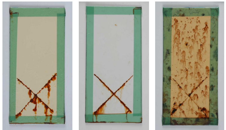
塩鉄錆ケレン+ CCP+ハイパネ 264時間試験後
